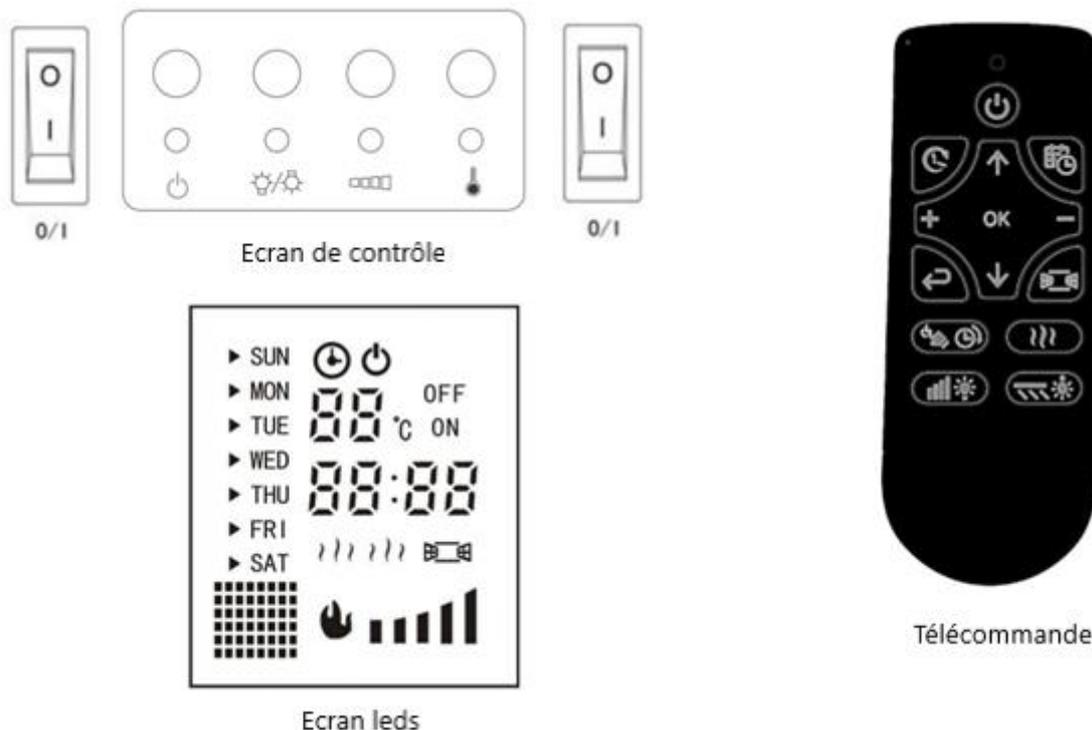
**O/I (droite)** : Appuyez sur cet interrupteur, l'appareil s'allume. Lorsque le commutateur O/I est désactivé, toutes les autres fonctions s'arrêtent même si les boutons sont en position ON.
